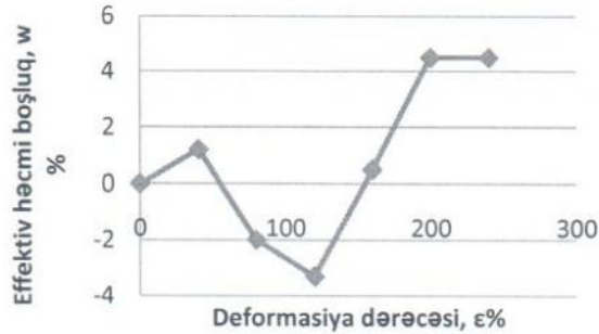
Şəkil 2. Polietilen təbəqənin effektiv həcmi boşluğunun onun deformasiya dərəcəsi ilə asılılığı. Əyri-polietilen təbəqə elektrik qaz boşalması şəraitində modifikasiya olunmayıb.
