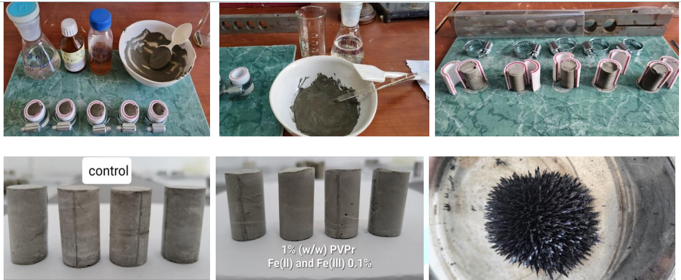
Şəkil 6. Sement qarışıqlarının hazırlanması və bəzi beton nümunələrinin görüntüləri
